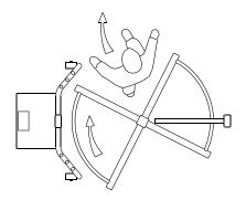
STEP 3B: READER CONFIRMATION - ACCESS DENIED TURNSTILE ROTATES 90° IN REVERSE AND RELOCKS
