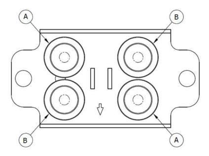
Figure 15: Staggering 4 Springs (Dissimilar springs)
