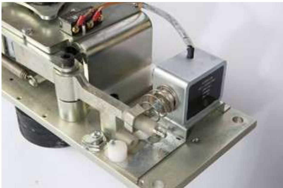
Abbildung 28: Solenoid im Fehlersicher Arrangement
