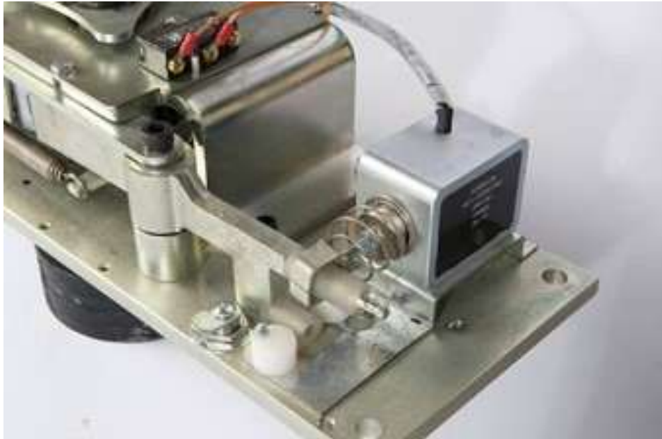
Abbildung 16: Solenoid im Fehlersicher Arrangement
